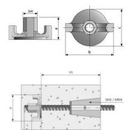
Für einseitige Verankerungen. Die maximale Belastung hängt von der Betongüte und der Verankerungstiefe (Vt) ab. Kompatibel mit Uni 15.
