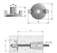
Für einseitige Verankerungen. Die maximale Belastung hängt von der Betongüte und der Verankerungstiefe (Vt) ab. Kompatibel mit Uni 15.
