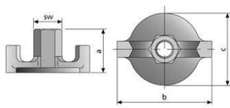
Für einseitige Verankerungen. Die maximale Belastung hängt von der Betongüte und der Verankerungstiefe (Vt) ab. Kompatibel mit Uni 15.
