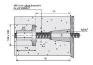
Hergestellt aus Ankerplatte mit angeschweißter S-Mutter B 20. Für einseitige Verankerung. Kompatibel mit Uni 20.
