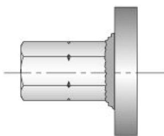
Hergestellt aus Ankerplatte mit angeschweißter S-Mutter B 20. Für einseitige Verankerung. Kompatibel mit Uni 20.
