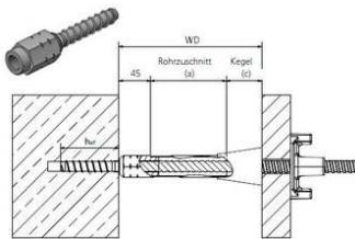
K-TEC-MS® von BETOMAX® systems dient zur einseitigen Verankerung in bestehenden Betonuntergründen.
