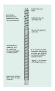
K-TEC-3s© von BETOMAX® systems ist mehrfach wiederverwendbar und vereint die Vorteile der temporären Maschinenbefestigung mittels eines Grobgewindes mit den Vorteilen einer selbstschneidenden Betonschraube.
