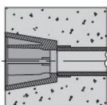
Extrem widerstandsfähiger Kegel für die Herstellung einer wasserundurchlässigen Spannstelle. Die große Auflagefläche verhindert Druckschäden an der Schalung.
