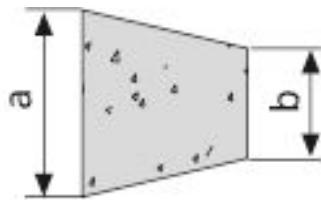
Zum Verschließen von Kegellochern. Wird mit 2-Komponenten-Kleber oder Beton-Kleber eingeklebt.
