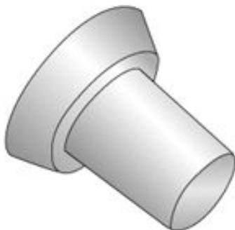
Zum Verschließen von Kegellochern. Wird mit 2-Komponenten-Kleber oder Beton-Kleber eingeklebt. 1 kg 2-Komponenten-Kleber reicht für ca. 150 Betonstopfen. Auch für vertieften Einbau (Schattenfuge) mit Kegel EX 22/15 geeignet.
