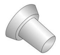
Zum Verschließen von Kegellöchern. Wird mit 2-Komponenten-Kleber oder Beton-Kleber eingeklebt. 1 kg 2-Komponenten-Kleber reicht für ca. 150 Betonstopfen. Auch für vertieften Einbau (Schattenfuge) mit Kegel EX 22/15 geeignet.
