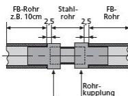
Verbindungsstück aus Kunststoff für Distanzrohr Stahl 22 mit Distanzrohr FB 22.
