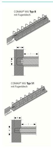
Comax® WU - Der selbstdichtende Bewehrungsanschluss Speziell für den Einsatz von Bewehrungsanschlüssen in WU-Bauteilen Bewehrungsanschluss in Kombination mit den bewährten Abschalelementen aus dem COMAX®-Boardsystem Als Abdichtung wird ein beschichtetes Fugenblech FB 120 eingesetzt
