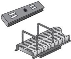
PU-Magnet für die Befestigung von COMAX® auf Stahlschalung. Leicht einsetzbar und ausbaubar dank Schraubgewinde.
