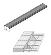
Hervorragende Verbundwirkung der Bleche durch Profilierung und Perforierung Standardlängen von 0,83 m, 1,25 m und 2,50 m Lochdurchmesser und Abstände variabel Kein Ausschalen oder teilweises Freistemmen im Bereich der Schalung Bei Standardabmessungen kostenlose Lochung
