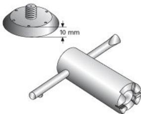
Nagelteller zur Befestigung von GripTec GTB-Muffenstäben (M) auf der Schalung.
