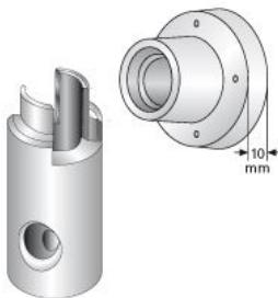
Anschluss-Nagelplatte zur Befestigung von GripTec GTB-Anschlussstäben (A) auf der Schalung.
