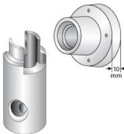
Anschluss-Nagelplatte zur Befestigung von GripTec GTB-Anschlussstäben (A) auf der Schalung.
