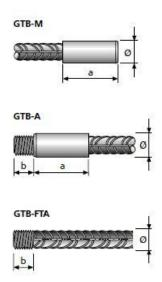
Standardverbindung GripTec GTB-A oder GTB-FTA + GTB-M für frei drehbare und längsverschiebliche Anschluss-/ Muffenstäbe.
