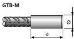
Standardverbindung GripTec GTB-A oder GTB-FTA + GTB-M für frei drehbare und längsverschiebbliche Anschluss-/ Muffenstäbe.
