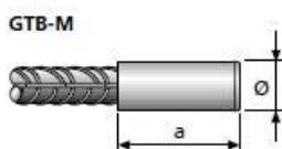
Standardverbindung GripTec GTB-A oder GTB-FTA + GTB-M für frei drehbare und längsverschiebbare Anschluss-/ Muffenstäbe.
