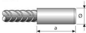
Reduzierverbindung GripTec GTB-R für frei drehbare und längsverschiebbliche Anschluss-/ Muffenstäbe mit unterschiedlichen Durchmessern.
