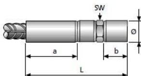
Positionierverbindung GripTec GTB-P I / P I repair für nicht-frei drehbare und längsverschiebbliche Anschlussstäbe (PI).
