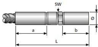
Positionierverbindung GripTec GTB-P II für nicht-frei drehbare und/oder nicht-längsverschiebbliche Anschlussstäbe (PII).
