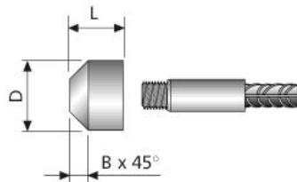
Anschweißmuffe GripTec GTB-AN zum Anschluss von B 500 B an Stahlbaukonstruktionen.
