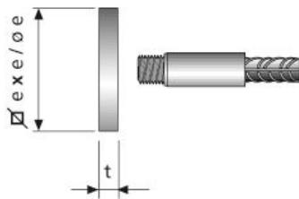
Endverankerung GripTec GTB-EV zur Abtragung der Stabkraft im Beton über eine Ankerplatte.
