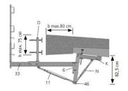
Für weit auskragende Kappengesimse im Brückenbau.
