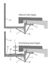
Neue Sanierungskonsole mit Sanierungsriegel.
