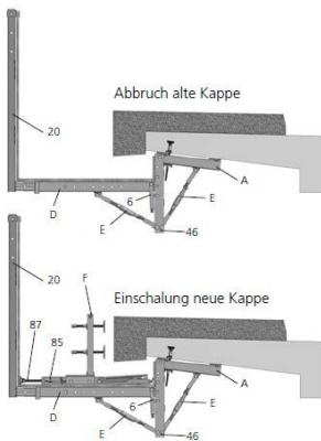
Neue Sanierungskonsole mit Sanierungsriegel.
