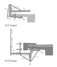
Konsole wird während des Transports auf das Fertigteil geklappt. Nach Setzen des Fertigteils nur umklappen und sofort einsatzbereit.
