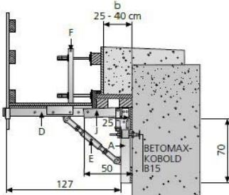
Für schmale Kappen im Rampen- bzw. Flügelbereich, sowie an Stützwänden.
