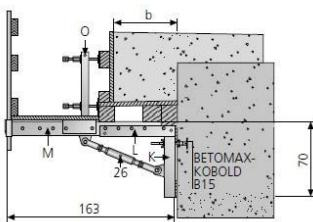
Für große Kappengesimse im Rampen- bzw. Flügelbereich, sowie an Stützwänden.
