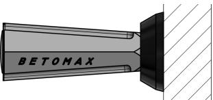
Die Climax ST® - Verankerungshülse ist für den Einsatz von einseitigen Verankerungen mit Betomax 15 Schalungsankern vorgesehen. Sie findet ihren Einsatz bei Deckenrandabschalungen, Konsolen, Gerüsten, einhäuptiger Schalung bei geringerem Schalungsdruck.
