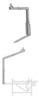
Kranaufnahme als Hilfe zur Montage der vormontierten Gesimskonsolen.
