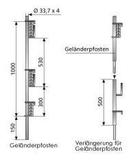
Gemäß den Sicherheitsregeln für Seitenschutz und Dachschutzwände als Absturzsicherung bei Bauarbeiten (BG-I 807 vom Oktober 2002). In Anlehnung an DIN EN 12811.
