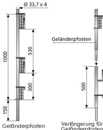
Gemäß den Sicherheitsregeln für Seitenschutz und Dachschutzwände als Absturzsicherung bei Bauarbeiten (BG-I 807 vom Oktober 2002). In Anlehnung an DIN EN 12811.
