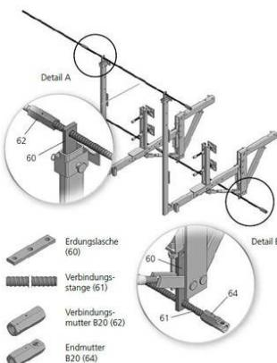
Zur Erdung des Kappengerüstes über elektrifizierten Bahnstrecken.
