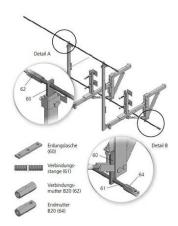
Zur Erdung des Kappengerüstes über elektrifizierten Bahnstrecken. Genehmigung der DB vorhanden.
