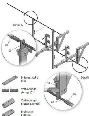
Zur Erdung des Kappengerüstes über elektrifizierten Bahnstrecken.
