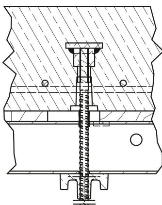
Befestigungsteil mit metrischem Gewinde, Verschluss mit Stopf 26.
