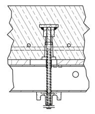
Befestigungsteil mit metrischem Gewinde, Verschluss mit Stopf 26.
