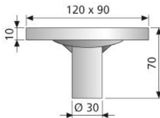
Zur Befestigung von Gesimskonsolen an Bauteilen ohne einbetonierte Verankerungsteile, z. B. bei Sanierungsarbeiten an bestehenden Bauwerken.
