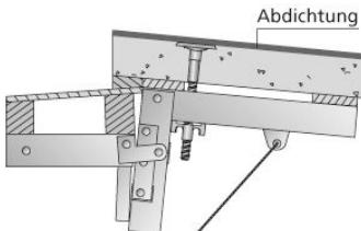
Zur Befestigung von Gesimskonsolen an Bauteilen ohne einbetonierte Verankerungsteile, z. B. bei Sanierungsarbeiten an bestehenden Bauwerken.
