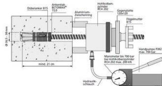
Zum Befestigen von einseitiger Schalung in Beton- oder Felswänden.
