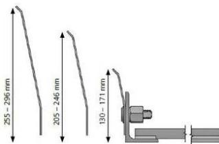
Kappenschalung, fahrbahnseitig mit höhenverstellbarem Stahlblech auf Trägerprofil zur Bordausbildung gemäß den RiZ-ING Kap 1-5, 6, 7, 9 und 10. Zusatzbauteil: S-Träger-Verlängerung 200 zur Vermeidung von Abdichtungsdurchdringungen im Schrammbord-Bereich bei Aufdübelung.
