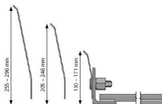
Radial einstellbare Kappenschalung, fahrbahnseitig mit höhenverstellbarem Stahlblech auf Trägerprofil zur Bordausbildung gemäß den RiZ-ING Kap 1-5, 6, 7, 9 und 10.
