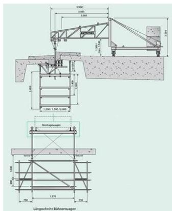
Diese Kombination wird speziell im Bereich der Mittelgesimse eingesetzt. Die Bühnenplattform bietet ideale Voraussetzungen für Montagearbeiten und Sichtkontrollen unter der Brücke. Der Verkehrsfluss auf der befahrenen Brückenseite wird nicht beeinträchtigt.
