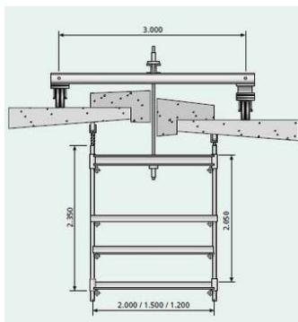
Fahrbare Arbeitsbühne zur rationellen Montage von BETOMAX®-Gesimskonsolen und Rohrleitungen oder Kontrollsichten bzw. Sanierungsarbeiten unter Mittelkappenbreichen von dicht nebeneinander befindlichen Brückenüberbauten.
