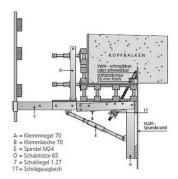
Mit der BETOMAX®-Spundwandkonsole 2000/70-s ist es möglich, Kopfbalken auf Spundwandprofilen sicher und rationell herzustellen. Dabei können alle Vorteile der BETOMAX®-Gesimskonsole 2000 im Hinblick auf Verstellmöglichkeiten und Sicherungseinrichtungen (z. B. Laufsteg mit Geländerpfosten) genutzt werden.
