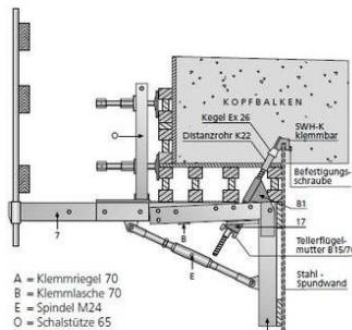
Mit der BETOMAX®-Spundwandkonsole 2000/70-k ist es möglich, Kopfbalken auf Spundwandprofilen sicher und rationell herzustellen. Dabei können alle Vorteile der BETOMAX®-Gesimskonsole 2000 im Hinblick auf Verstellmöglichkeiten und Sicherungseinrichtungen (z. B. Laufsteg mit Geländerpfosten) genutzt werden.
