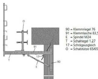
Mit der BETOMAX®-Spundwandkonsole 2000 / 83,5 ist es möglich, Kopfbalken auf Spundwandprofilen sicher und rationell herzustellen. Dabei können alle Vorteile der BETOMAX®-Gesimskonsole 2000 im Hinblick auf Verstellmöglichkeiten und Sicherungseinrichtungen (z. B. Laufsteg mit Geländerpfosten) genutzt werden.
