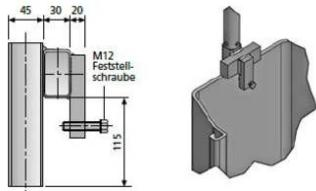
Geländerpfostenhalter zur sicheren Montage von BETOMAX® Geländerpfosten auf Spundwandprofilen und ähnlichen Bauteilen mit einer Materialstärke bis 27 mm.
