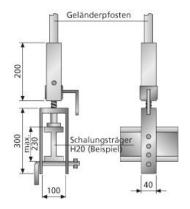
Klemmbare Geländerpfostenhalterung. Geeignet für Holzträger und Stahlprofile.
