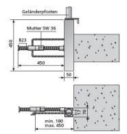
Geländerpfostenhalter zur Aufnahme von BETOMAX®-Geländerpfosten an Überbaurändern von Brücken.
