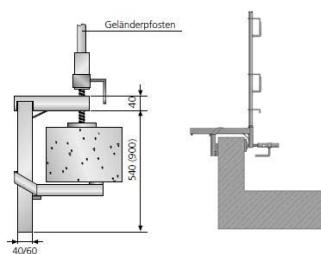
Klemmbare Geländerpfostenhalterung für senkrechte und waagerechte Bauteilränder.
