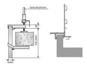
Klemmbare Geländerpfostenhalterung für senkrechte und waagerechte Bauteilränder.
